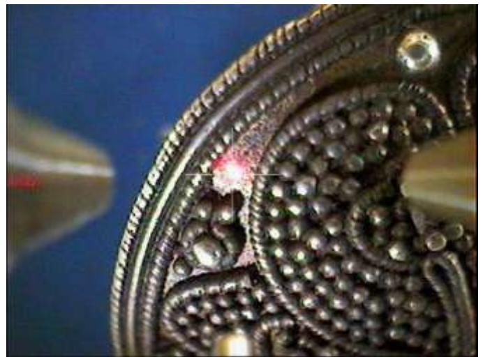
Рис. 10. Прибор ArtTAX для неразрушающего анализа элементного состава металлов и сплавов с фиксацией положения образца по отношению к рентгеновскому излучению (фотографии Н.В.Ениосовой)
