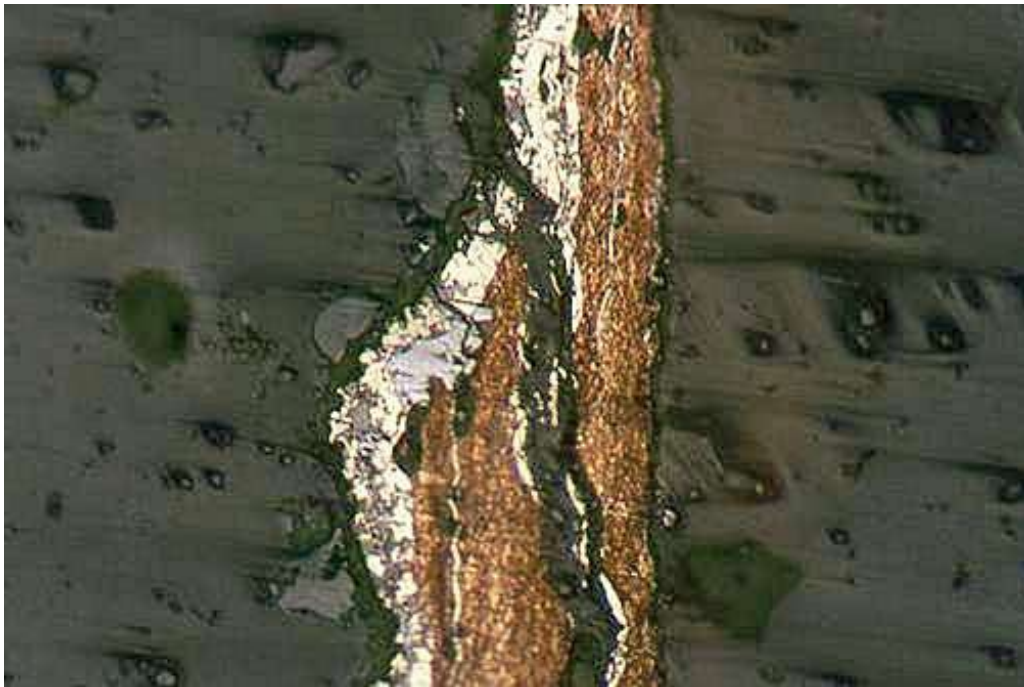
Рис. 3. Структура кинжала при увеличении 200. Светлая кромка – ликвационное покрытие (фотография Н.В. Рындиной)
