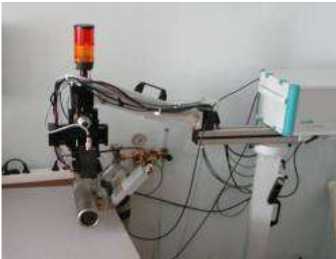
Рис. 10. Прибор ArtTAX для неразрушающего анализа элементного состава металлов и сплавов с фиксацией положения образца по отношению к рентгеновскому излучению (фотографии Н.В.Ениосовой)
